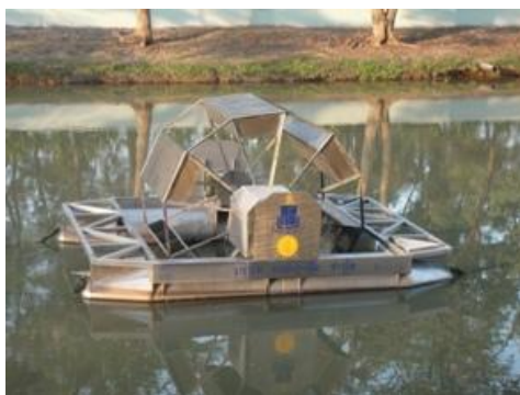
▲王立農業博物館にも展示されていた酸素を送る水車が大学の敷地にも展示されている。実際に稼働しているものも構内の数箇所で見られる。
