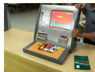
▲ID カードを差し込み、図書を所定の場所に置いて IC チップを読みこむと手続きができる自動貸出装置
